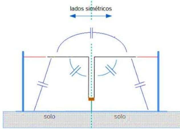
Vale ressaltar que não basta ser uma linha aberta para o conjunto linha/antena estar balanceado. Ela tem que estar perpendicular à antena porque, de outra forma, apresentará acoplamentos capacitivos e indutivos diferentes com os braços da dipolo, alterando as correntes de excitação na linha de transmissão e alterando os campos da antena e o seu diagrama de radiação.
